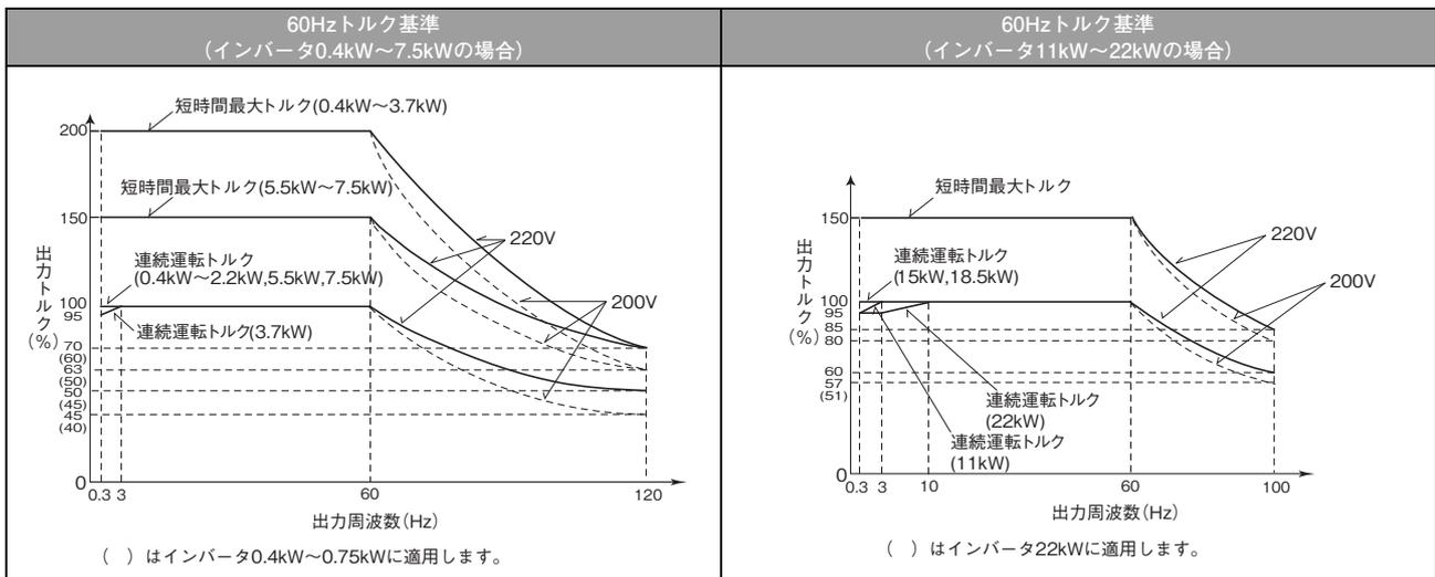
短時間最大トルクは、60s以内の最大トルク特性を示します。
