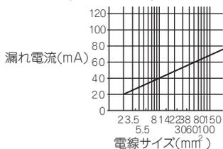
3相誘導電動機の商用電源運転時の漏れ電流例 (200V 60Hz)
