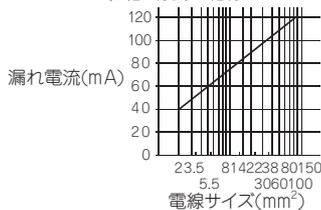
3相誘導電動機の商用電源運転時の漏れ電流例 (全閉外扇形電動機400V60Hz)
