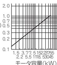
CVケーブルを金属管配線した場合の商用電源運転時の1kmあたりの漏れ電流例 (3相3線式△結線400V60Hz)
