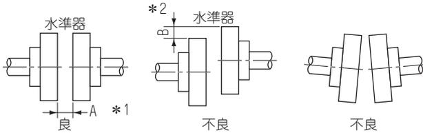
\*1 A寸法がどの位置をスキマゲージで測っても同一寸法となるようにする(Aの幅不同 3/100mm 以下)。
