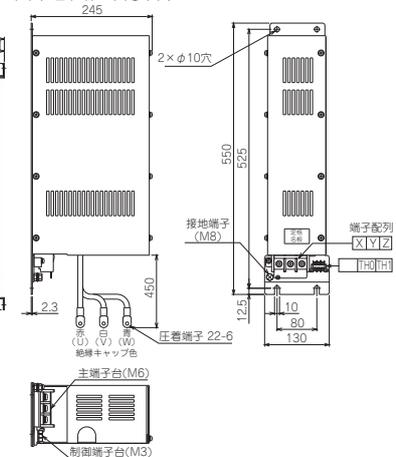
サージ電圧抑制フィルタ
