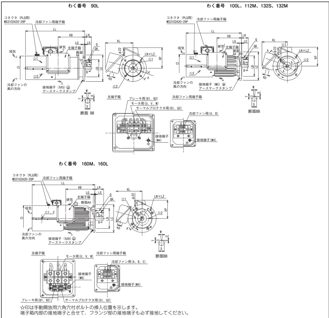
☆印は手動開放用六角穴付ボルトの挿入位置を示します。
