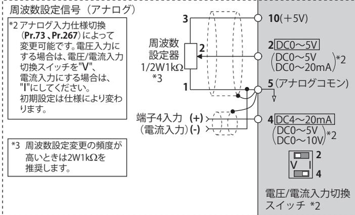
\*2 アナログ入力仕様切換 (Pr.73、Pr.267) によって変更可能です。電圧入力にする場合は、電圧/電流入力切換スイッチを"V"、電流入力にする場合は、"I"にしてください。初期設定は仕様により変わります。
