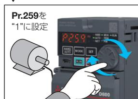
モーターが接続されて停止中であることを確認した後、Pr.259に“1”を設定します。
