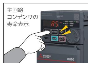
Pr.259が“3”になっていれば測定完了です。Pr.258を読み出すと、出荷時のコンデンサ容量を100%として、劣化度合いをパーセント表示します。85%以下で寿命と判断してください。
