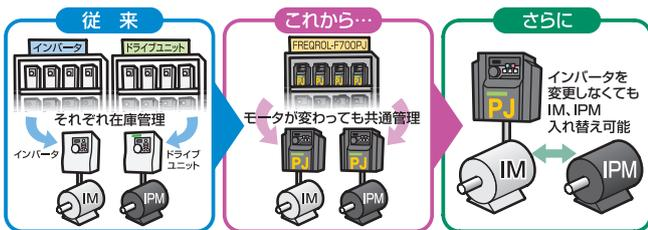
(2) 汎用モータからIPMモータへの置換えも安心、簡単
