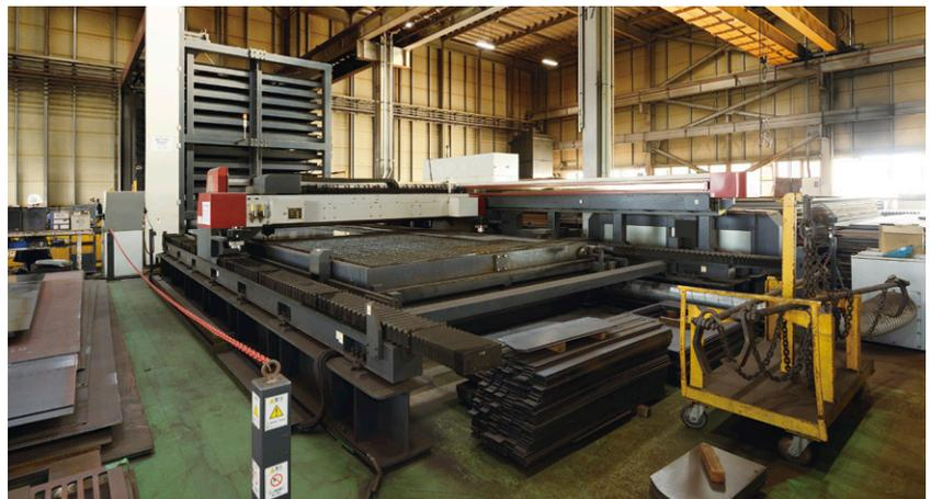
6100×3050mmの大型鋼板まで対応できる4.5kWのCO<sub>2</sub>レーザ加工機「ML6030XL-45CF-R」。こちらも12段のパレットチェンジャを搭載している。
