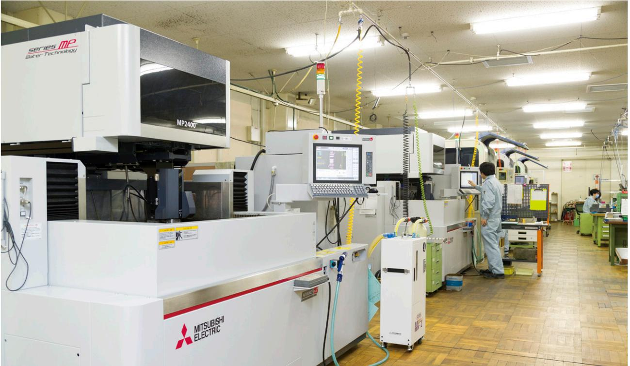
三和工場の「放電加工室」。ここでは計16台の放電加工機が稼働しており、うち10台が三菱電機の製品だ。
