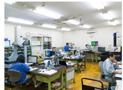
「検査室」には3次元計測器やレーザ顕微鏡など各種の測定機器が並んでいる。
