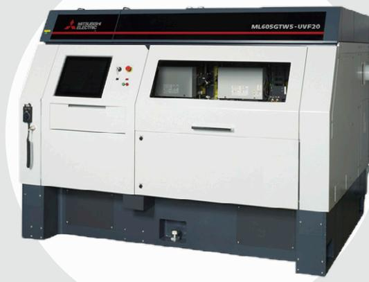
▲2018年5月に発売したフレキシブル基板の穴あけ用UVレーザー加工機「GTW5-UVF20シリーズ」。従来機種に比べて最小穴径を30 $\mu\text{m}$ から20 $\mu\text{m}$ に微細化した。
