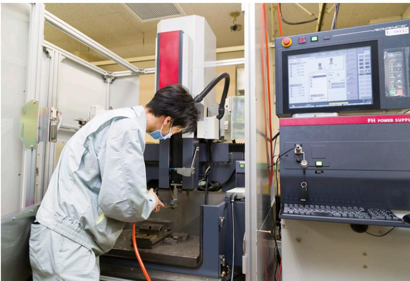
2018年7月に導入した三菱電機製細穴放電加工機「SH12」。加工前に担当者が調整している様子。
