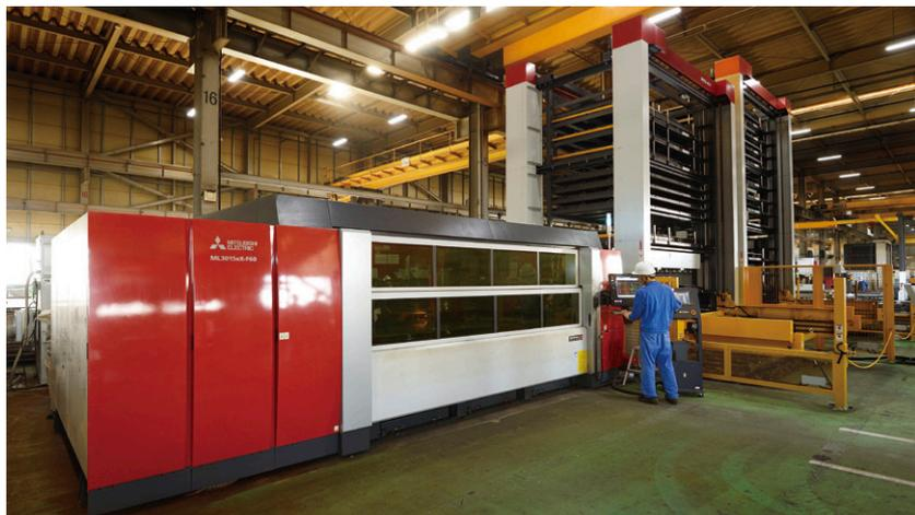
2017年に導入した6kWのファイバレーザー加工機「ML3015eX-F60」。日本初となるツインタワー方式のパレットチェンジャ(10段+12段)を搭載している。
