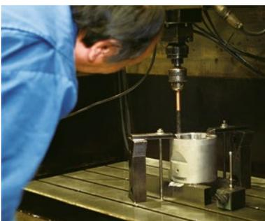
特殊加工に対応するには、高い技術力が要求される。使用している形彫放電加工機は全て三菱電機の製品で、長く使用している加工機も多い。
