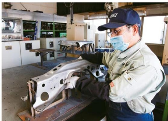
「CamMagic TL-II」で加工経路を作成し、三菱電機の三次元レーザ加工機で製造したトラック部品の試作品。
