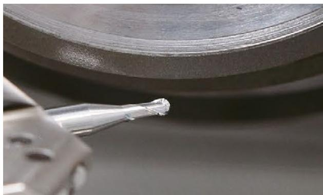
超硬エンドミルは超硬合金製のワーク（写真中央の先のとがった部材）をダイヤモンド砥石（その上）で研削加工して製造する。
