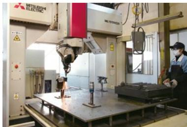
プレス工場で加工中の三菱電機製三次元レーザ加工機「ML1515VZ20」。
