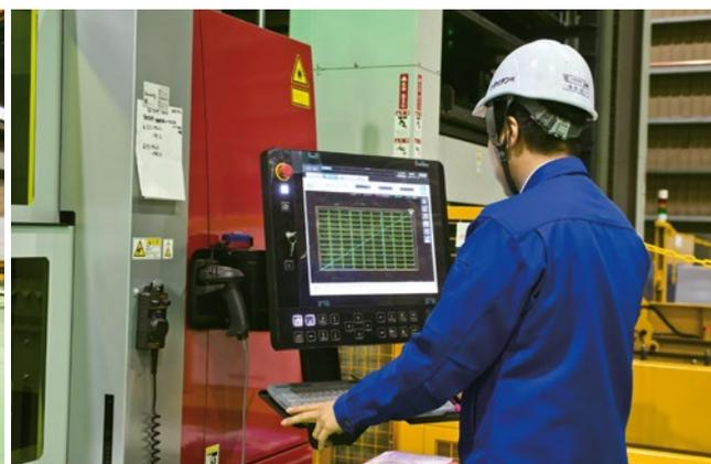
2018年に導入した三菱電機の6kWファイバレーザ加工機「ML3015eX-F60」。15段のバレットチェンジャ搭載機と6段のシートチェンジャ搭載機は、ともに夜間でも自動運転することを可能にしている。
