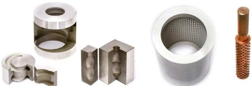
加工サンプルの例。左端は、円形のワークに渦巻き状の穴を加工したサンプル。その後ろは円筒計のワーク内部をらせんに加工したサンプル。その右下は表面の加工口は狭いが、内部は広がっていくように加工したサンプル。右から2番目は円筒形のワークの内部に半球状のパターンを多数加工したサンプル。右端はその電極。
