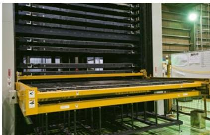
加工中の6kWファイバーレーザー加工機「ML3015eX-F60」(左)。中央は鋼板を加工して製造した部品。2台導入したレーザー加工機のうち1台は15段のパレットチェンジャを搭載しており、加工機へ鋼板を自動的に搬入出することができる(右)。
