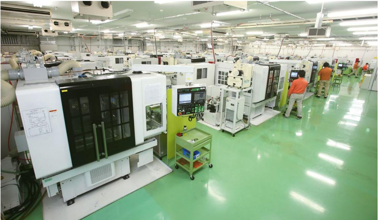
仙台工場の工具研削盤の約6割が、自社開発した「TGM」だ。
