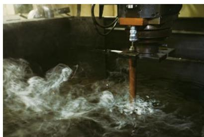
直径1350mmの巨大ワークをセットした三菱電機の形彫放電加工機「M85KC7」(左)。右は加工中の様子。
