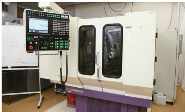
2006年に完成した「TGM」の1号機。現在は開発センターに設置して、超硬小径エンドミルの新製品の試作に活用している。
