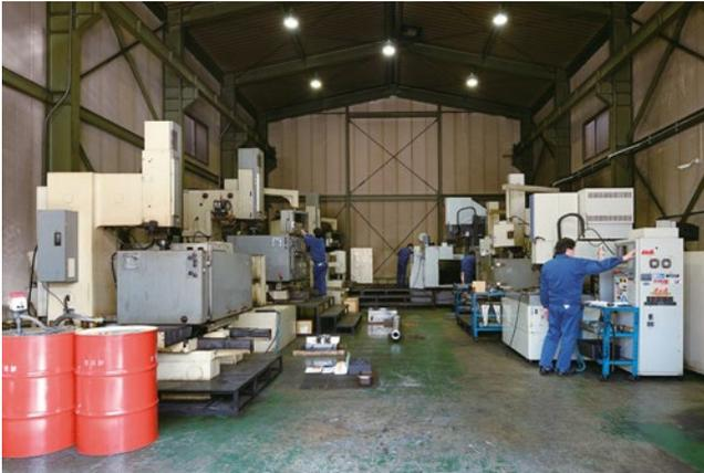
大型のワーク用の加工室。三菱電機の大型放電加工機がズラリと並んでいる。
