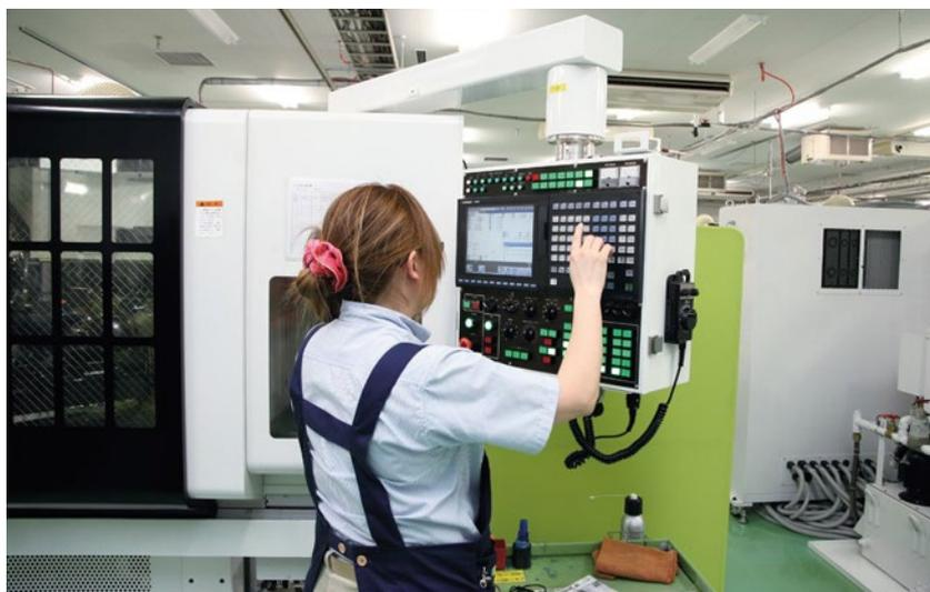
自社開発した工具研削盤「TGM」。CNCには三菱電機の「M750VW」を採用している。
