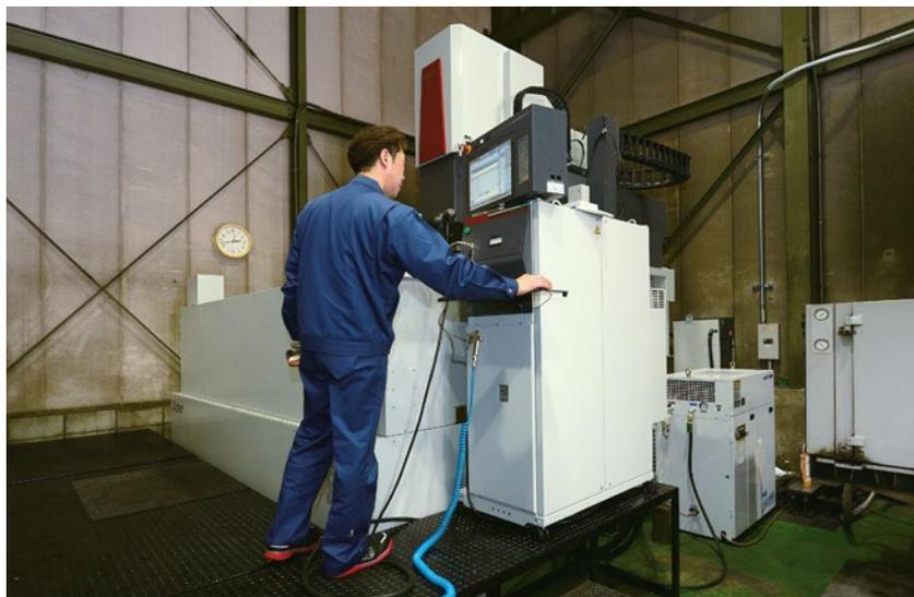
2019年1月に導入した三菱電機製形彫放電加工機「EA40M」。2200×1500mmという超大型の加工槽を備えている。
