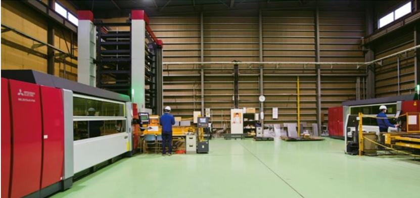
「ML3015eX-F60」を2台導入した。左のファイバレーザ加工機は6段のシートチェンジャを搭載している。
