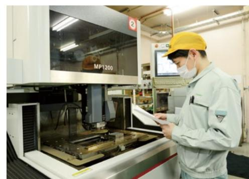
大阪事業部のシールドルームに並べて設置してあるワイヤ放電加工機「MP1200」。三菱電機の加工機は画面が大きくクリアで見やすいと評価されている。
