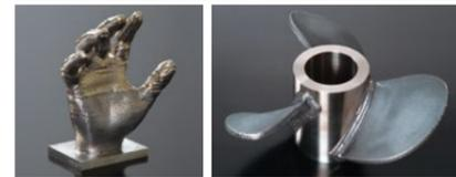
3Dスキャナを使用した中空の造形例 φ300の船舶用プロペラ製作例 加工時間と廃棄材料を約80%削減<sup>※4</sup>
