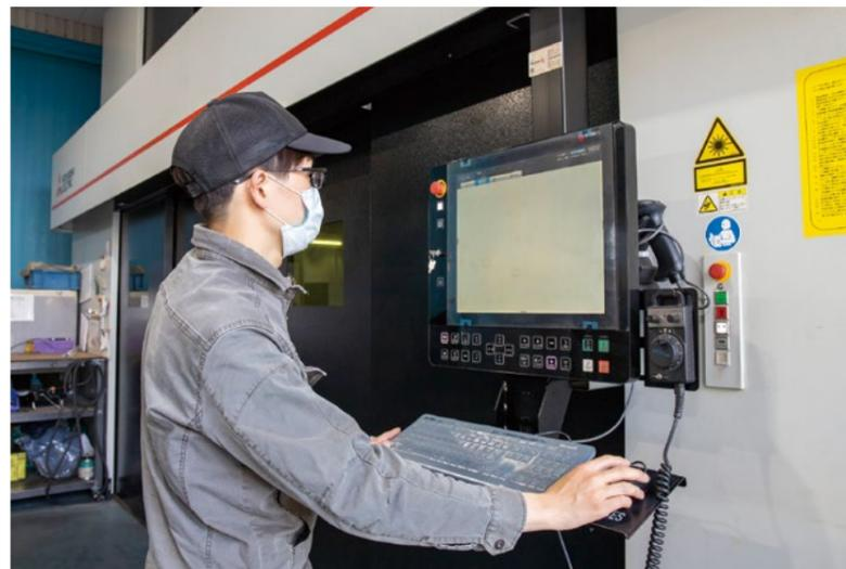
3次元ファイバレーザ加工機「ML4020FV1」では、0.3~6mmまでの板厚を加工するという。
