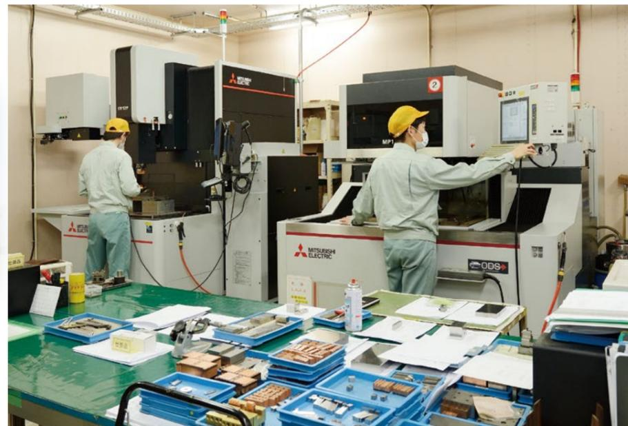
「SV12P」と「MP1200」で加工を行っているところ。シールドルーム内には他社製加工機も並んでいるが、三菱電機の2台は手のひらサイズなど大きめの加工を行える点で利便性が高いという。「仕上がりの精度が高いので、納期ギリギリでも安心な点もありたいです」と作業者の一人は語る。ちなみにこの右には2008年導入の電極加工機「MEM-02S」が並ぶ。
