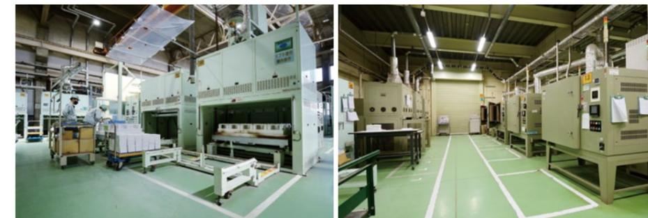
セラミックスの大型の焼成炉(左)や脱脂炉(右)が所狭しと並び、ファインセラミックスの射出成形においては他社の追随を許さない豊富な設備を取り揃えており、同社独自のニッチな価値創出に力を発揮している。
