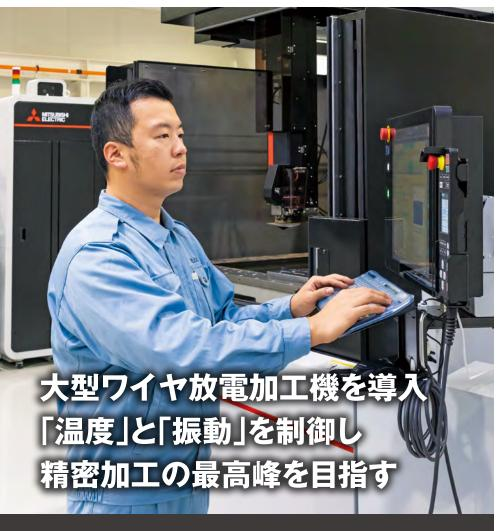
厚物・長尺ニーズに応え、「大物に強い」を自認する静岡県浜松市のブローチ研削工業所。積極的な設備投資により、ワイヤ放電加工機や形彫放電加工機など約80台を保有する。2015年に建設された本社工場は、「温度」と「振動」が徹底的にコントロールされ、今なお最先端の設備を誇る。24年10月には、新たに800mmまでの大型品を加工できる三菱電機のワイヤ放電加工機「MV4800S(Z810仕様)」が導入された。先端設備と人財育成により精密加工の最高峰を追求し続ける。
