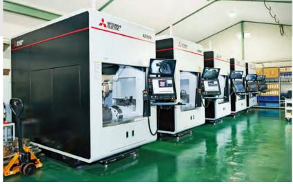
ラボ施設「MML」に設置された5台のAZ600。軸指令値、ワイヤ送給量、レーザ出力などが最適に協調制御できる。「24時間運転も可能」(下木氏)
