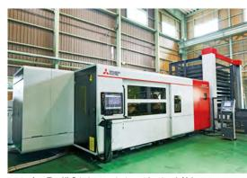
2024年1月に導入したパレットチェンジ・ストッカ付きの 金属切断用レーザ加工機ML3015GX-F80。
