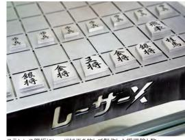
ステンレス鋼板にレーザ加工を施して製作した将棋盤と駒。 技術力の高さが表われている。
