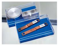
レーザ溶接は板厚が大きくても対応可能(上)、 電子ビーム溶接は銅も精緻に溶接できる(下)。
