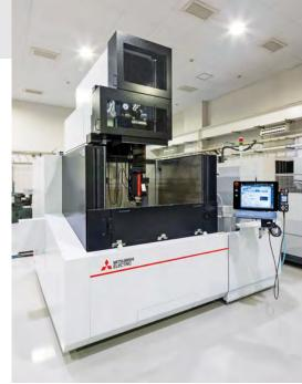
2024年10月に導入された三菱電機のワイヤ放電加工機 MV4800S(Z810仕様)。日本国内では1号機となる。
