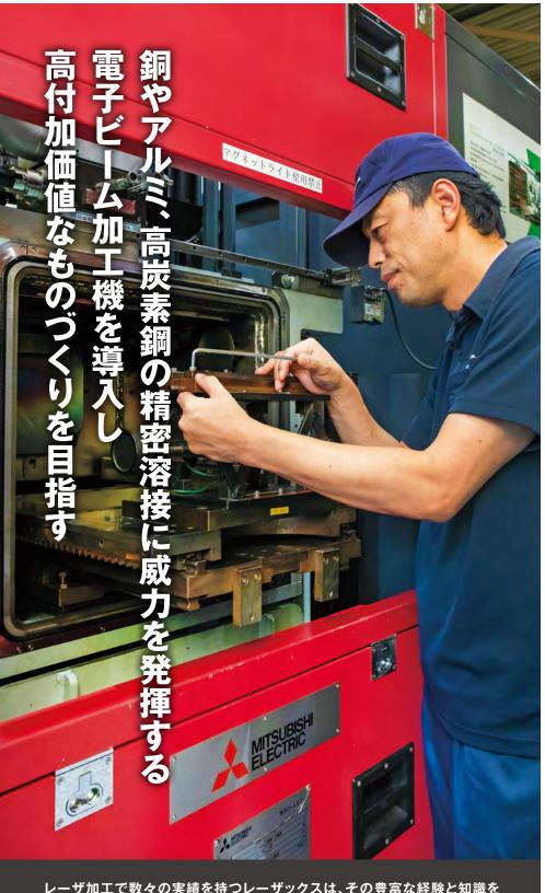
レーザ加工で数々の実績を持つレーザックスは、その豊富な経験と知識を生かし、電子ビーム加工に挑んでいる。電子ビーム加工は、レーザでは困難な銅やアルミ合金、高炭素鋼といった金属の溶接に威力を発揮し、特に半導体製造装置部品の精密溶接にはなくてはならない存在だ。ものづくりの現場において、三菱電機の電子ビーム加工機がどのように活躍しているかお話を伺った。
