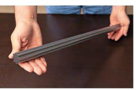
ワイヤ放電加工機による長さ600mmのサンプル 加工品。金属ブロックから精密に切り出している。
