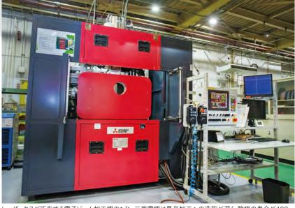
レーザックスが所有する電子ビーム加工機の1台。三菱電機は量産加工への造詣が深く、陰極の寿命が400~600時間と長いのが特徴だ。そのため、メンテナンスによるロスタイムを大幅に削減できる。これらの電子ビーム加工機は三菱電機の関係会社である多田電機が製造を担当している。
